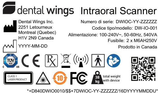
Figure 12: Etichetta del dispositivo – Modello 001
